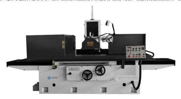
程控磨床操作规范有什么? 1、开机前,应按工件磨削长度,调整好左右撞块的极限挡块,并锁紧。2、安装砂轮必须进行平衡,修正后应再次平衡,砂轮修整器的金刚石必须尖锐,其尖点高度应与砂轮中心线的水平面一致,禁止用磨钝的金刚石修整砂轮,修整时,必须启动吸尘器。3、启动磨床主轴空转1到2分钟,观察运转情况,应注意砂轮离台面5公分左右高度;确认润滑冷却系统畅通,各部运转正常无误后再进行磨削作业。4、检查工件、装卸砂轮、处理机床故障要将砂轮退离工件后停机进行。安徽高精度程控磨床厂家程控磨床作业前,应检查传动部分安全护罩是否完整、固定。
