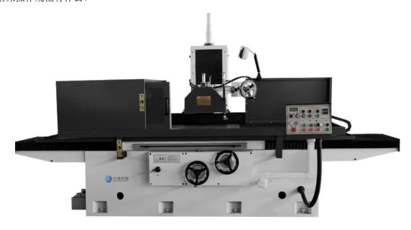
怎么让有用的前进程控磨床精度的办法: 1. 主要件的制作精度需前进。2. 整机安装的精度前进。3. 要前进程控磨床的精度,那么机床构造方面也需求改进。先前进砂轮架主轴、头架主轴组件的旋转精度,刚度以及抗振性,如用整体式多油楔动压滑动轴承或静压轴承; 电动机等细心动平衡, 运用无接头平皮带传动; 前进微量进给精度, 避免匍匐, 前进横向进给传动链刚性, 不经齿轮直接用丝杠螺母传动, 静压导轨或抗振性较好的闭式翻滚导轨; 前进机床的刚度及减小振荡, 选用双壁床身, 在振源下加防振垫等; 减少发热及热变形, 热源远离机床, 配预热器, 冷凝器, 机床放于恒温车间; 配高精度主动测量仪; 配高净化能力的冷却液净化设备,冷却液要清洗。程控磨床应在较大运动空间外再预留三百毫米以上。安徽高精度程控磨床厂家
